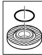
**针对 M 14 主轴的固定法兰：**在固定法兰 9 的定心轴环上有一个塑料零件（O 形环）。如果缺少 O 形环或 O 形环损坏了，必须在安装固定法兰 9 之前，换上新的 O 形环（O 形环的物品代码：1 600 210 039）。
