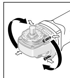
机器操作者可根据需要分段式转动机头，每一段的旋转角度为 90 度。此功能的优点是能够在特殊的工作状况下，把起停开关移动到比较容易操作的位置，例如针对左撇子。
