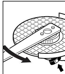
Un écrou de serrage rapide non endommagé qui a été correctement fixé peut être desserrée à la main en tournant l'anneau moleté dans le sens inverse des aiguilles d'une montre.
