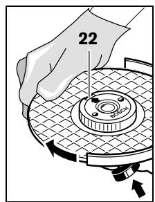
Afin de bloquer la broche de ponçage, appuyez sur la touche de blocage de la broche **1**. Afin de serrer l'écrou de serrage rapide, tournez fortement la meule dans le sens des aiguilles d'une montre.
