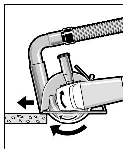
เปิดเครื่องทำงาน และวางส่วนหน้าของแผ่นสำหรับตัดบนชิ้นงาน เก็บอุ่นเครื่องไป ชั่วหน้าด้วยความเร็วพอ ประมาณที่เหมาะสมกับลักษณะงานที่กำลังตัดอยู่
