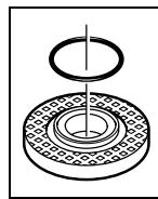
**Flens untuk poros kerja M 14:** Di dalam flens untuk poros kerja **9** di sekitar tingkatan pemusatan ada satu bagian dari bahan sintetik (ring-O). **Jika ring-O ini tidak ada atau rusak,** mutlak harus diganti (nomor model 1 600 210 039) sebelum flens untuk poros kerja **9** dipasangkan.
