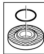
**Bích lắp cho trực máy mài có cỡ M 14:** Vòng đệm chữ O (bộ phận bằng nhựa) được lắp vào bích lắp dụng cụ 9 vòng quanh vòng tâm của bích lắp. **Nếu vòng đệm chữ O bị mất hay bị hư,** vòng phải được thay vào bằng mọi cách (mã số 1 600 210 039) trước khi bích lắp dụng cụ 9 được lắp vào.
