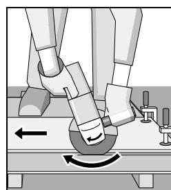
L'outil électroportatif doit toujours travailler en sens opposé. Sinon, il risque de sortir de la ligne de coupe **de façon incontrôlée**. Lors du tronçonnage de profils et de tuyaux carrés, il convient de positionner l'appareil sur la plus petite section.
