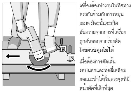
เครื่องต้องทำงานในทิศทางตรงข้ามกับการหมุนเสมอ มีอันตรายจากการที่เครื่องถูกดันออกจากตัวตัด โดยความคุณไม่ได้มีผลต่อการตัด เนื่องจากตัวตัดมีแรงต้านต่อการตัด เช่น รอบนอกและที่สี่เหลี่ยม ข้อแนะนำให้เริ่มตวงคุณที่มีหนาตัดที่เล็กที่สุด
