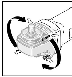
หัวเครื่องสามารถหมุนได้เป็นทิศทวน 90° ในลักษณะนี้ ท่านสามารถนำหัวเครื่องเปิดปิดไปยังตำแหน่งที่สะดวกต่อการใช้งานมากกว่าสำหรับสภาพการทำงานที่เฉพาะเจาะจง ต. ย. เช่น สำหรับผู้คนดื้อช้ำ
