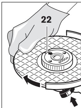
یک مهره مهار سریع سالم و بدون نقص را که به درستی محکم شده است، میتوان بوسیله دست از طریق چرخش حلقه شیاردار آن، در خلاف جهت حرکت عقریه ساعت باز کنید.
