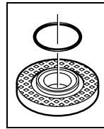
**針對 M 14 主軸的固定法蘭：**在固定法蘭 **9** 的定心軸環上有一個塑料零件（O形環）。如果缺少 O形環或 O形環損壞了，必須在安裝固定法蘭 **9** 之前，換上新的 O形環（O形環的物品代碼：1 600 210 039）。
