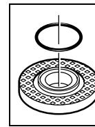
**Bride de fixation pour broche porte-outil M 14 :** Dans la bride de fixation 9, il y a une pièce en matière plastique (rondelle élastique) se trouvant autour de l'ergot de centrage. **Au cas où cette rondelle élastique ferait défaut ou qu'elle serait endommagée,** il faut absolument la remplacer (Référence 1 600 210 039) avant de monter la bride de fixation 9.
