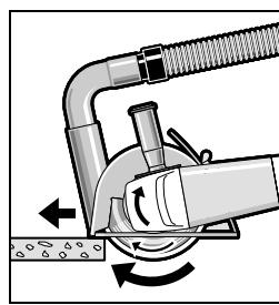
开动电动工具，并把导引装置的前端放置在工件上。参考工件的物料，适当地施力推进机器。
