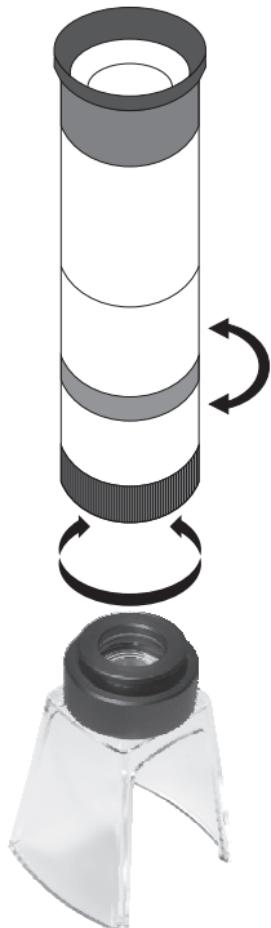
wania jako stojący mikroskop należy wkręcić przednią część ręcznego monokularu i po stronie obiektywu przykręcić do monokularu stojąca lupa.
