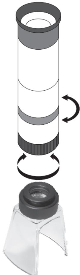
parte delantera del monocular manual y enrosque la lupa vertical del lado del objetivo al monocular manual.
