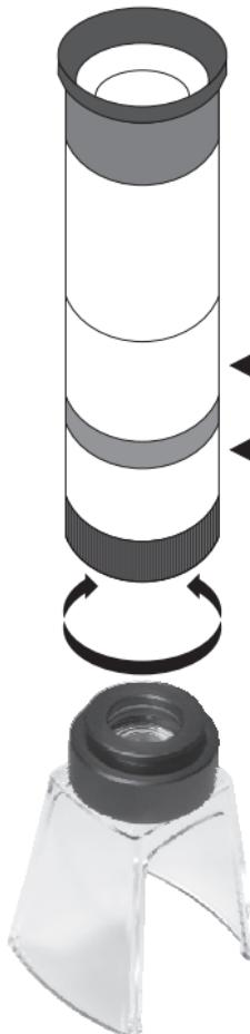
manuel vers l'extérieur. Pour une utilisation comme microscope fixe, tournez la partie avant du monoculaire manuel vers l'intérieur et vissez la loupe fixe côté objectif sur le monoculaire manuel.
